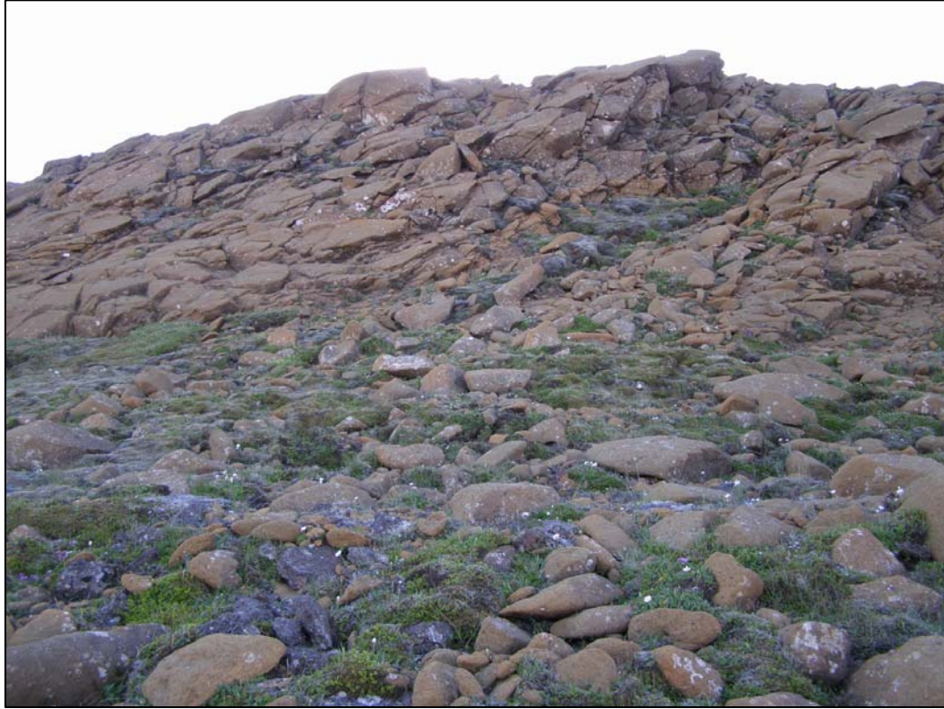
Mynd 5.10 Móbergstúff, sem er lélegt fyllingarefni, á yfirborði hæðar uppi á fjallinu við nyrðri mörk fyrirhugaðs efnistökusvæðis (lendir utan markanna).
